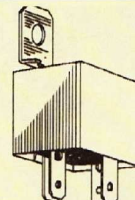
Mini Relay Change Over, 12 volt, 20 amps.
